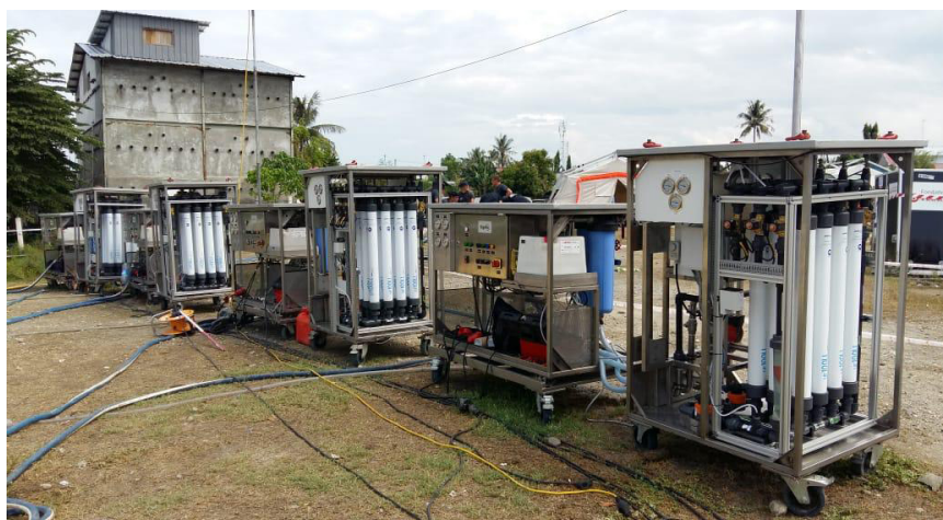
Station de traitement de l'eau déployée par la sécurité civile dans le cadre de l'aide humanitaire française à Palu.
